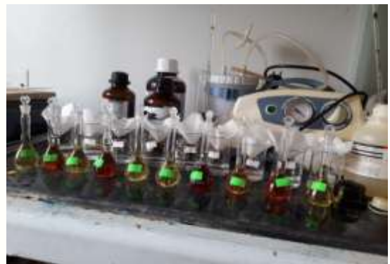
Hình 12: Phân tích chỉ tiêu phenol trong tủ hút
