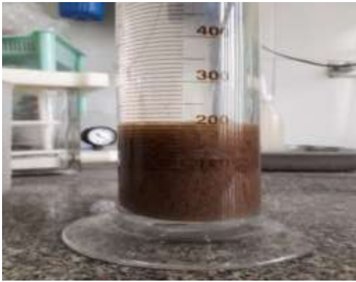
Hình 7: Phân tích chỉ tiêu SVI
