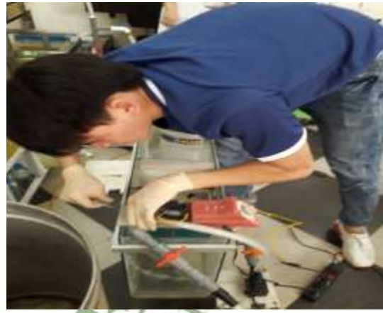
Hình 2: Lắp bơm nước thải dầu vào
