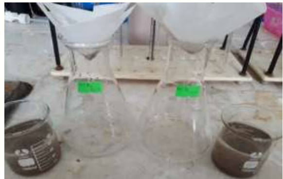
Hình 6: Phân tích chỉ tiêu MLSS
