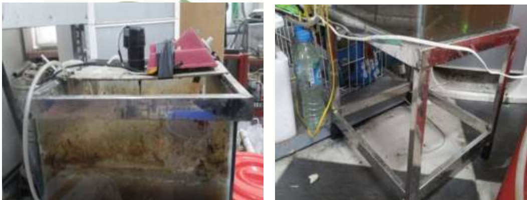
Hình 3.5. Khung giá đỡ của bể SBR
