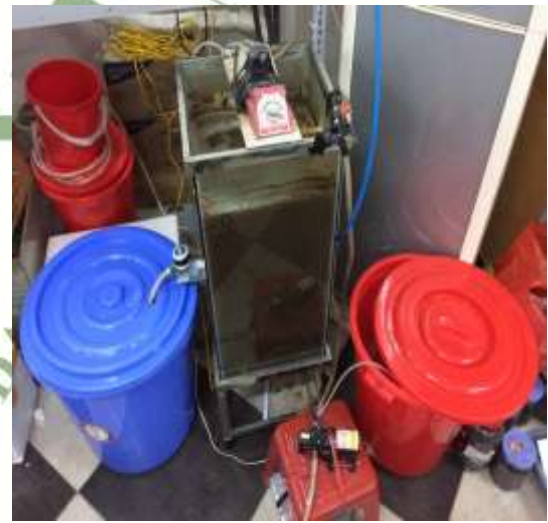
Hình 4: Bể SBR hoạt động
